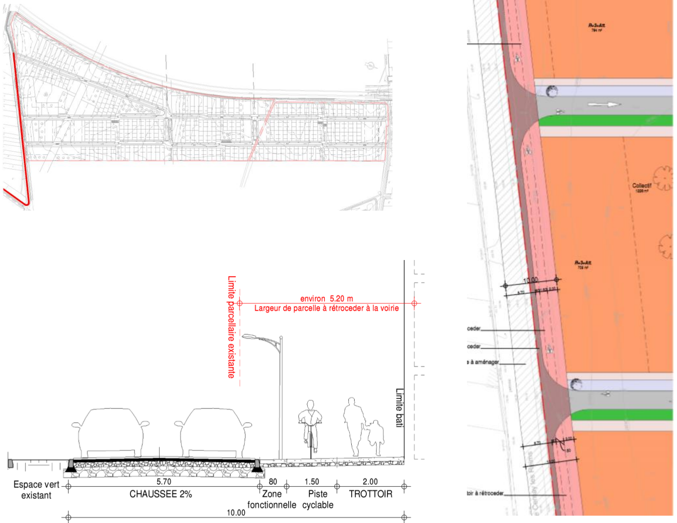
Figure 20 : Les différentes voiries (localisation, coupes) (Source : AWO)
